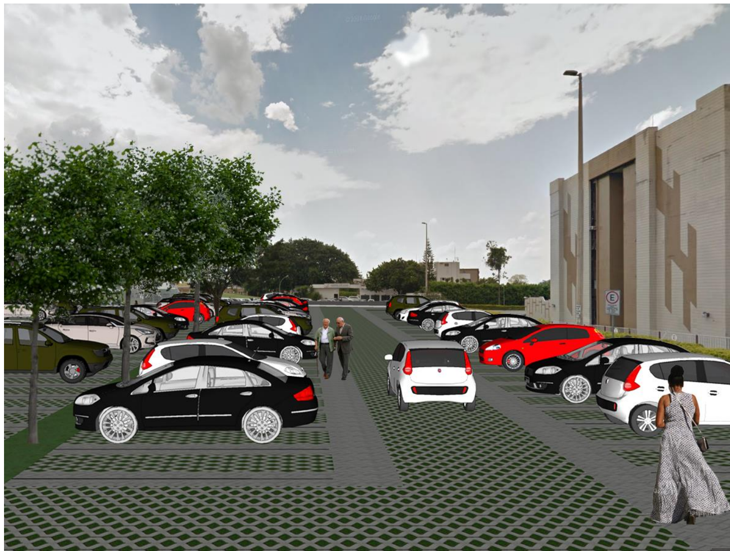
Simulação de estacionamentos com vagas a 90° e piso drenante acessível - Setor Hospitalar Local Sul
