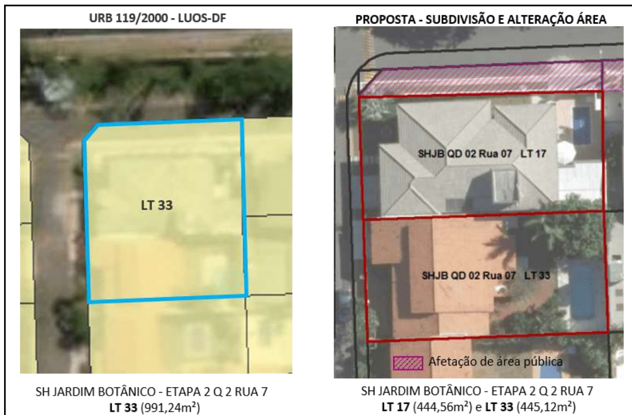
Figura 38: Parte 2 da Poligonal 14 - afetação de parte da área do lote 33, resultando no acréscimo de 101,56m² de área pública e subdivisão do lote 33, resultando nos lotes 17 e 33. Fonte: Geoportal e SEI 00111-00001455/2022-54, com adaptação desta Dilest.
