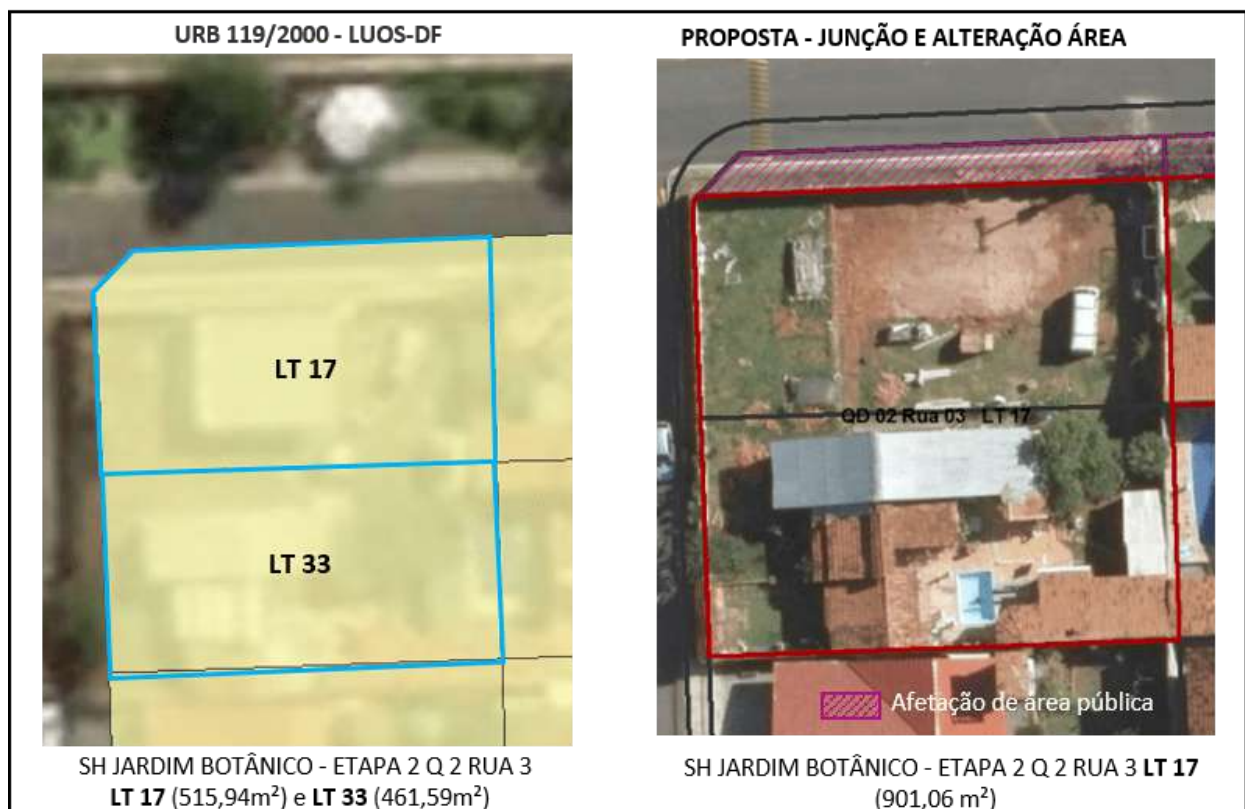
Figura 29: Parte 1 da Poligonal 10 - afetação de parte da área do lote 17, resultando no acréscimo de 76,47m² de área pública e junção das áreas dos lotes 17 e 33, resultando no lote 17. Fonte: Geoportal e SEI 00111-00001455/2022-54, com adaptação desta Dilest.
