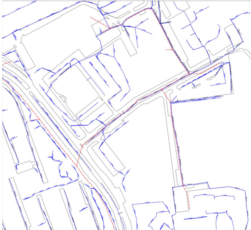
Figura 14 Trecho do documento SEI 64386807, Processo 00390-00001325/2021-88 que indica interferências no lote com a rede subterrânea da CEB.
