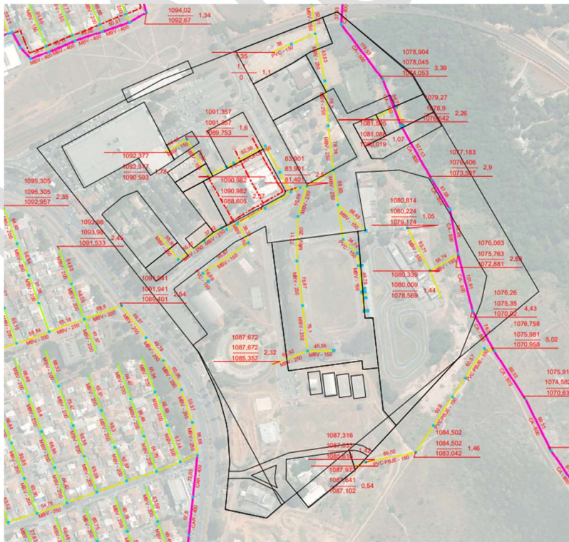
Figura 17 Trecho do documento SEI 57961802, Processo 00390-00001325/2021-88 que indica interferências no lote com a rede de esgoto implantada da CAESB.
