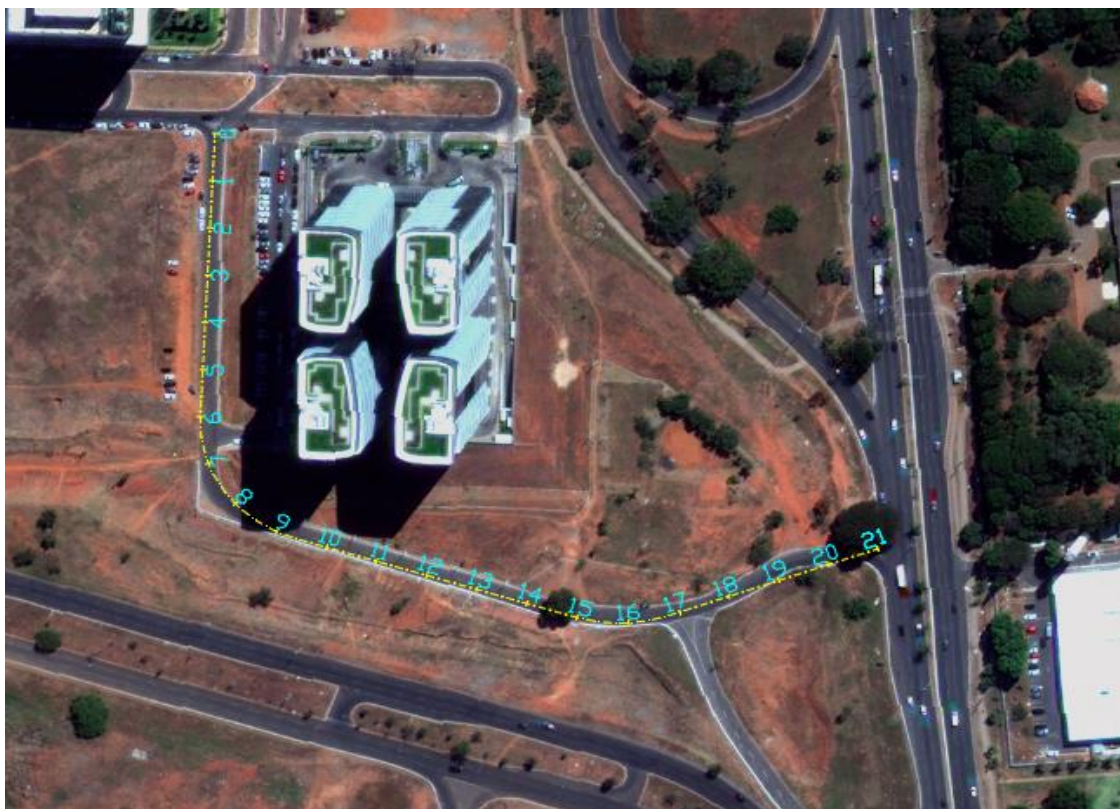
Figura 279 - Estacas do trecho (20m – 20m)
