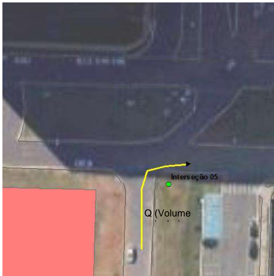
Figura 205 - Interseção não semaforizada – interseção 05
