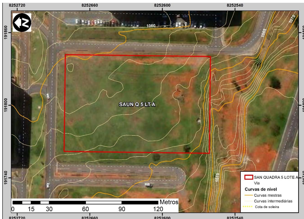
Figura 5 – Croquis de altimetria do lote A, elaborado com dados de levantamento a laser disponível no Geoportal SEDUH, acessado em 16/01/2023.
