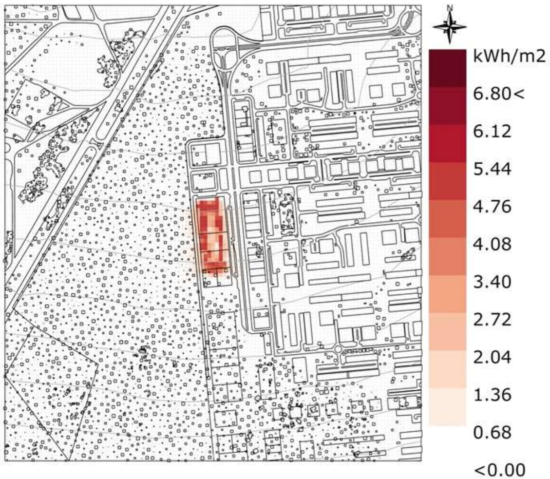
Figura 89 – Diagrama comparativo de radiação – Redução de kWh/m 2 no período de 21/06 – das 08h-18h – Comparativo entre os Cenários I e II.
