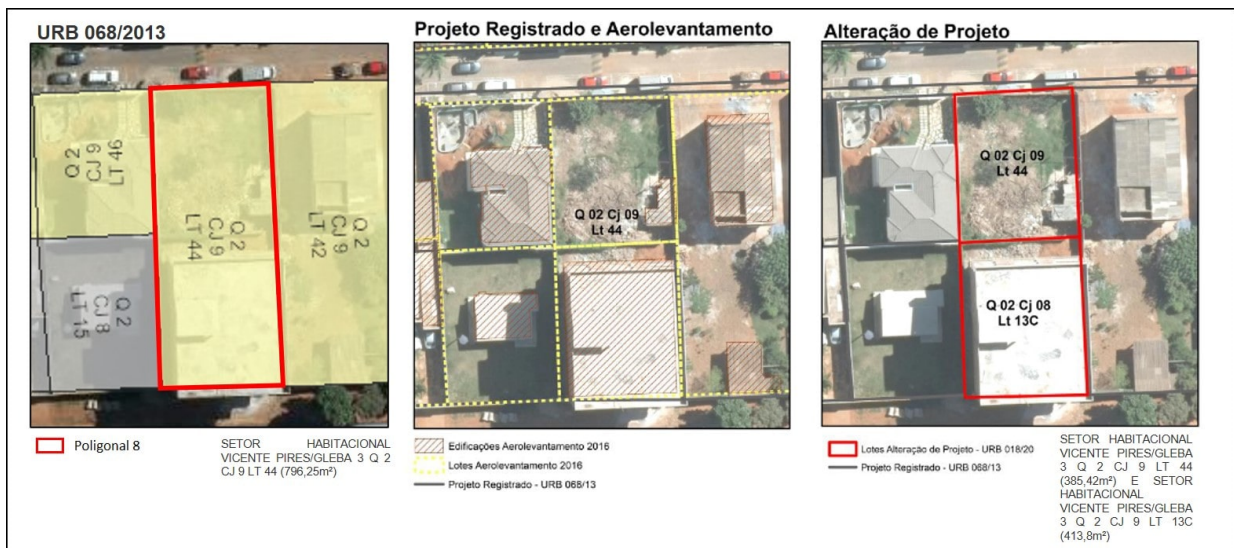
Figura 16 - Poligonal 8 - alteração de parcelamento tendo em vista a ocupação fática, em que foi proposta a criação de nova unidade imobiliária, culminando na alteração de dimensões e áreas
