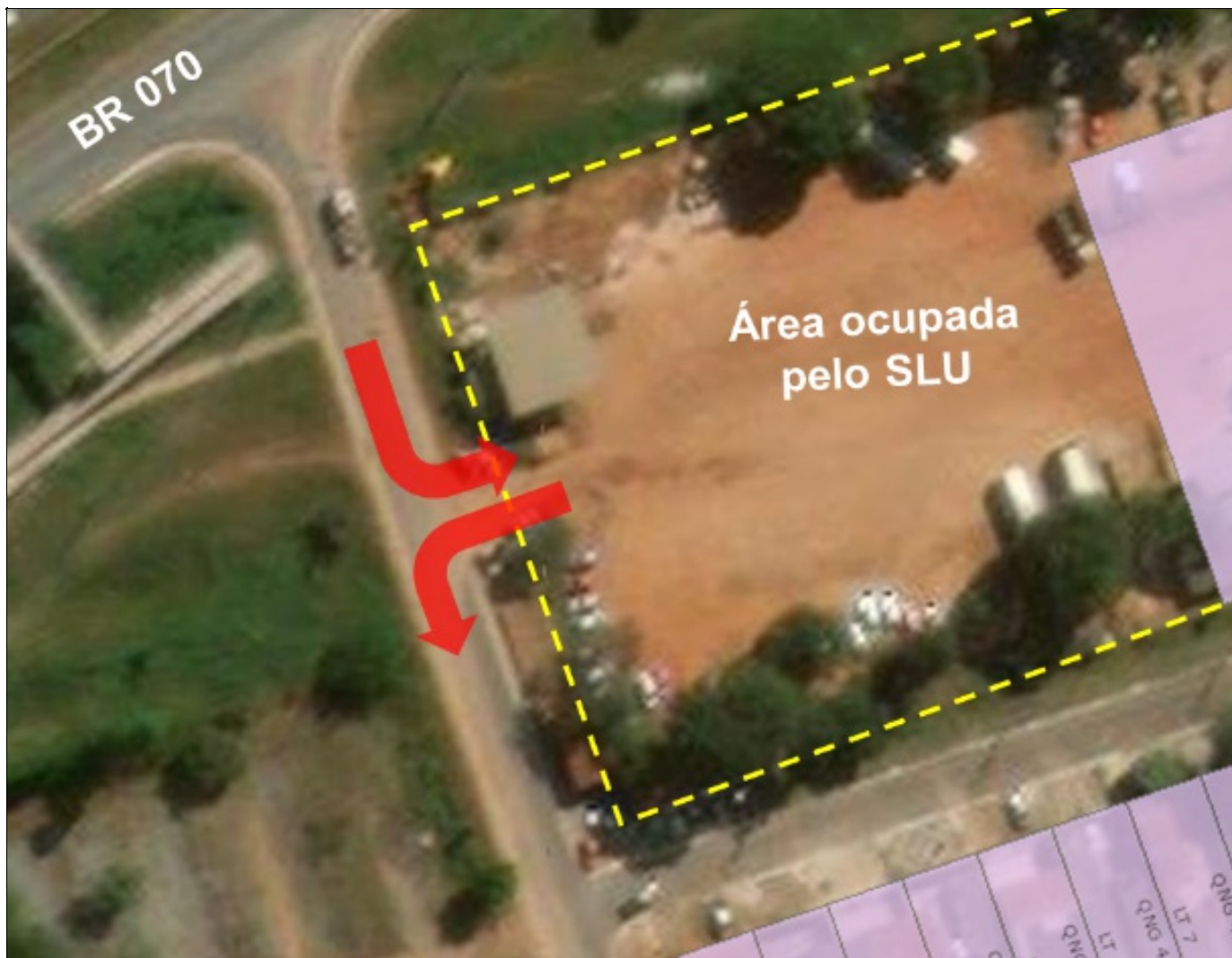
Figura 18: detalhe do conflito viário existente em função do acesso ao lote do SLU, elaborado pela DIOEST sobre a base Geoportal/SEDUH
