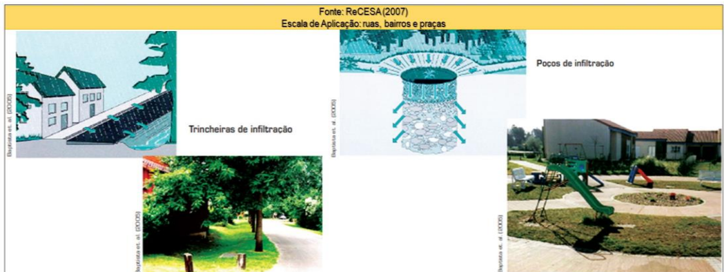
Figura 71: Exemplo de infraestrutura verde de drenagem urbana na escala da fonte
