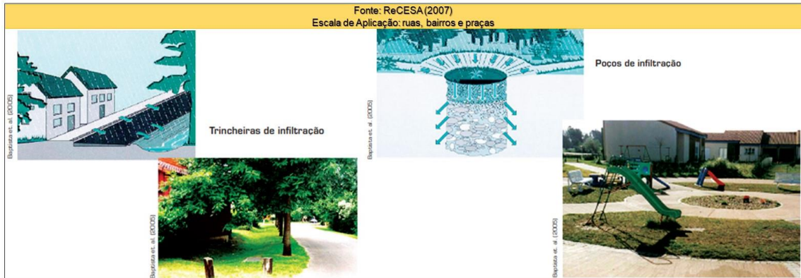
Figura 47: Exemplo de infraestrutura verde de drenagem urbana na escala da fonte
