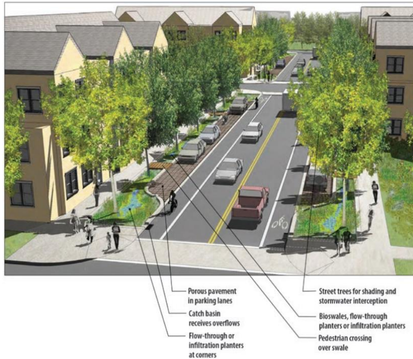
Figura 90: Exemplo de infraestrutura verde de drenagem urbana para Vias de Circulação de Vizinhança, Vias Parque e vias locais Fonte: Green Streets Handbook , 2021.
